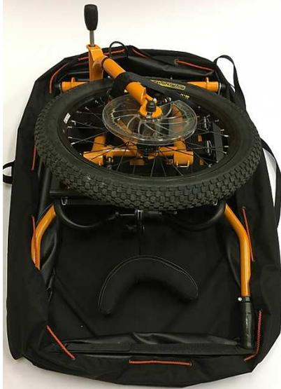
1 - Placer le châssis un l'intérieur du sac
