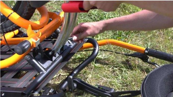
7- Remettre l'axe dans son logement et le bloquer vers l'intérieur. Puis remettre la goupille de sécurité.
