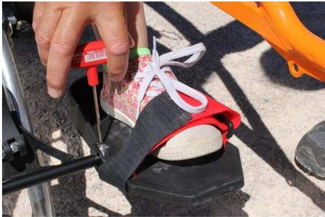
Régler l'inclinaison des planches à pied à l'aide de la clé 6 pans 3mm fournie.
