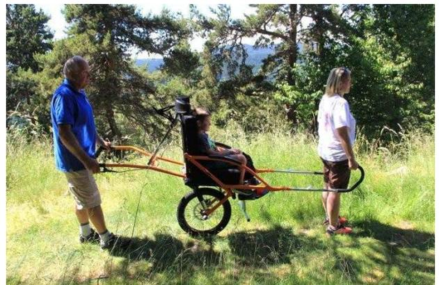
Une fois que le point d'équilibre est trouvé, le pilote arrière utilise le système de réglage du guidon arrière afin d'avoir les poignées à **hauteur de son bassin** :
