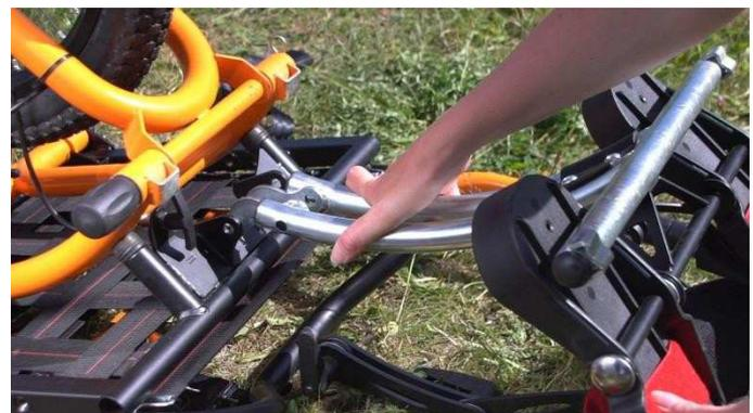
6- Positionner le pied dans les encoches tout en serrant les deux tubes afin de faciliter son insertion
